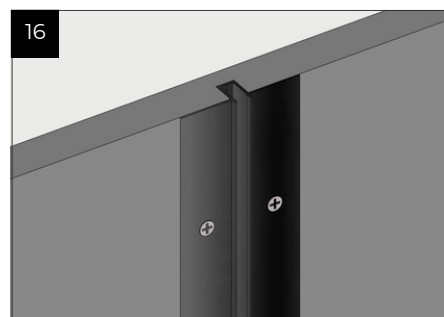
Perfil fixado na alvenaria
