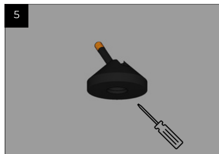
Ajustar a pressão da haste com auxílio de uma chave de fenda
