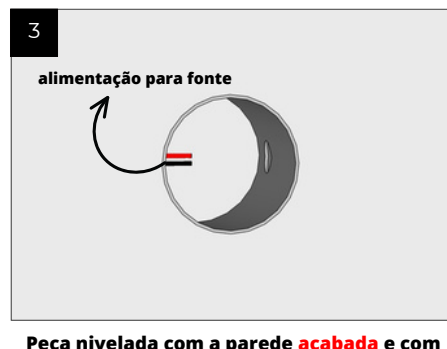
Peça nivelada com a parede acabada e com espera da alimentação
