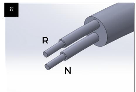
**Ligar retorno e neutro do driver com a alimentação elétrica conforme a imagem**
