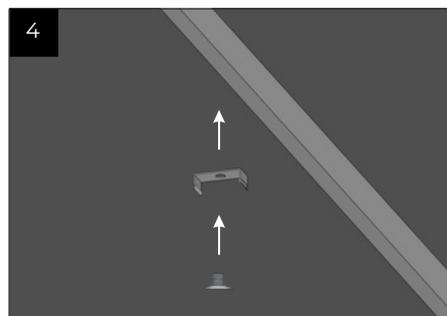
**Posicionar a mola de fixação no nicho e fixar com o parafuso**
