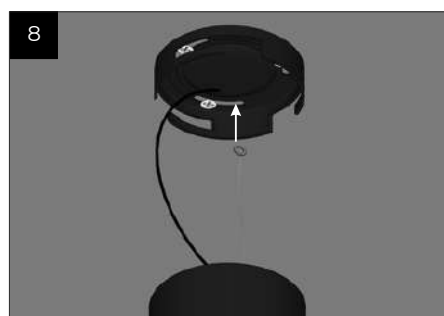
Parafusar o cabo de segurança no teto
